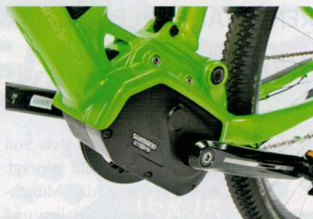
Der Shimano Steps Mittelmotor als Light Offroad Variante mit 50 Nm Drehmoment.
