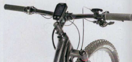
Cockpit des eBig.Nine: Shimano Display, Gabel Lockout, Bremsgriffe & Schalthebel.
