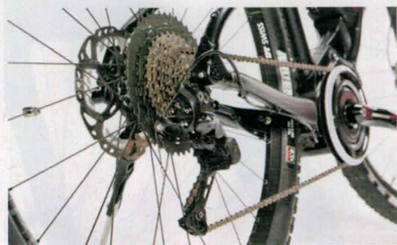
Auch Merida nutzt die Bandbreite der XT-Kassette mit Ritzeln von 11 - 46 Zähnen.
